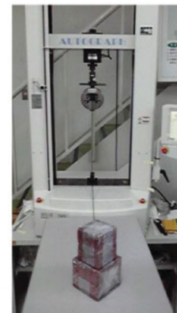
実験用頭部と微小引張試験機
