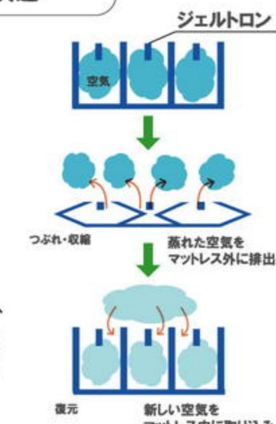
ジエルトロンは空気の層を多く含み、立体格子状ジェルの変形時に生じる「ポンピング作用」が発汗、失禁等による過度の湿潤を減らし、四季を通じて快適な寝床内環境をつくり出します。
